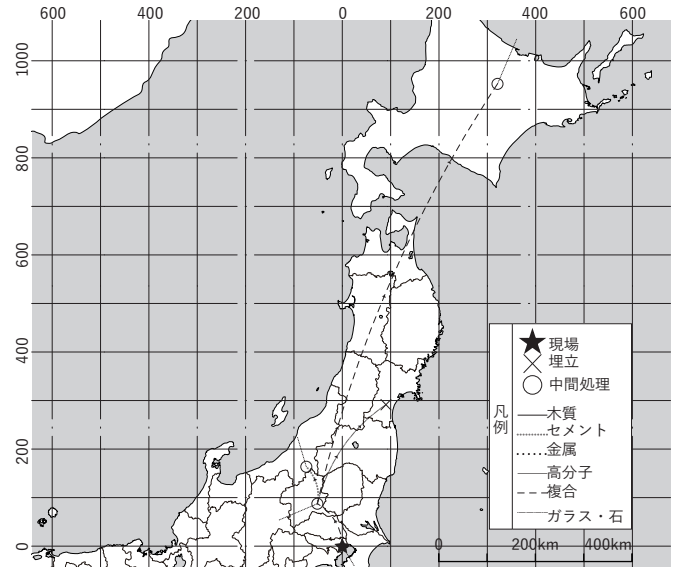
図8 Sビルの廃材のたどった経路
