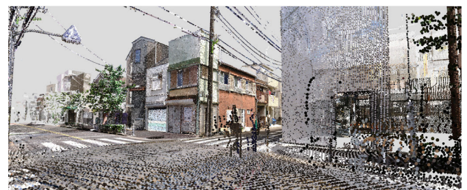
図4 レーザースキャナーで測定された点群
